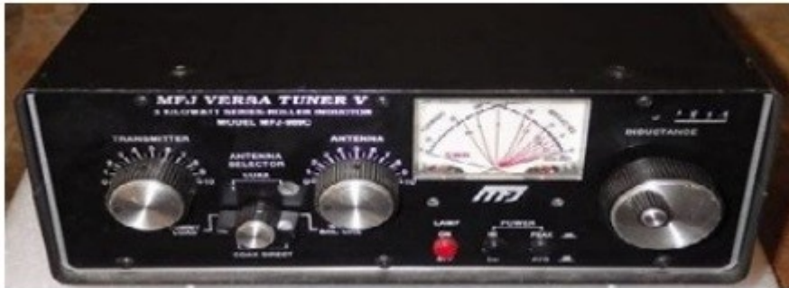
Bild 9.) unser Test-Objekt ca.) MFJ Versa Tuner 989C, Symmetrischer- Ausgang
