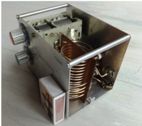
Bild 12.) unser Test-Objekt e.) Z-Match, 100W by HB9BXE
