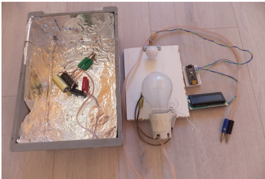
Bild 5.) Hier sehen wir das selbstgebaute Luxmeter
