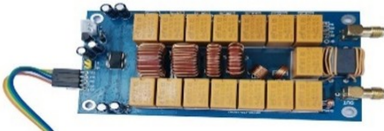
Bild 8.) unser Test-Objekt a, den ATU-100 ,by N7DDC
