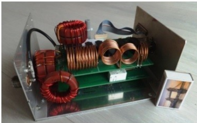
Bild 14.) unser Test-Objekt g.) Automatischer Tuner L-Glied by HB9BXE
