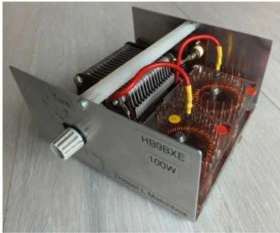
Bild 11.) unser Test-Objekt d.) Doppel-L Symmetrisch-Matchbox, by HB9BXE
